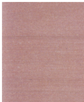
Rode Wezer/Bremer zandsteen, Wezer-gebergte (veel gebruikt voor onderdelen van gebouwen, bv. vensters, zuiltjes, lateien, dorpels, altaarstenen, sarcofagen e.d.)
