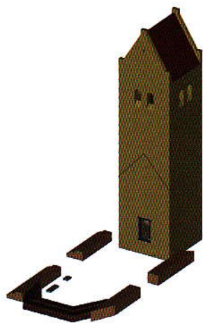
Tekening met hierop aangegeven de drie aangetroffen funderingen. Het smalle, grijze stukje is het oudste romaanse restant, gevolgd door de zware en brede gotische funderingen. Het bruine, hoekige stuk ertussen dateert uit 1708
